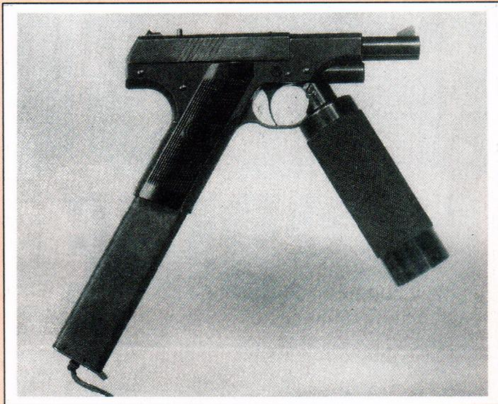
Deux modèles du pistolet Kimball. Ci-dessous, la version standard, ci-dessus, une version à canon plus court, pourvue d'un chargeur plus long et d'une poignée antérieure vissable donnant plus de stabilité à l'arme.
