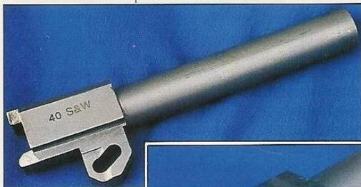
A destra, collocando la canna nella sua sede si può apprezzare il ruolo della rampa di alimentazione. Sotto, il guidamolla è realizzato in due parti saldate tra loro
