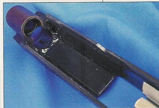
In alto, l'azionamento dell'abbatticane è agevole e solo ad arma nuova si deve vincere una certa resistenza. A sinistra, la canna è trattenuta nel castello in lega leggera per mezzo di un inserto in acciaio speciale. Sotto, particolare della saldatura della porzione anteriore del carrello
